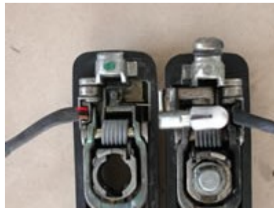
Der Vergleich ganzer und abgebrochener Hebel
